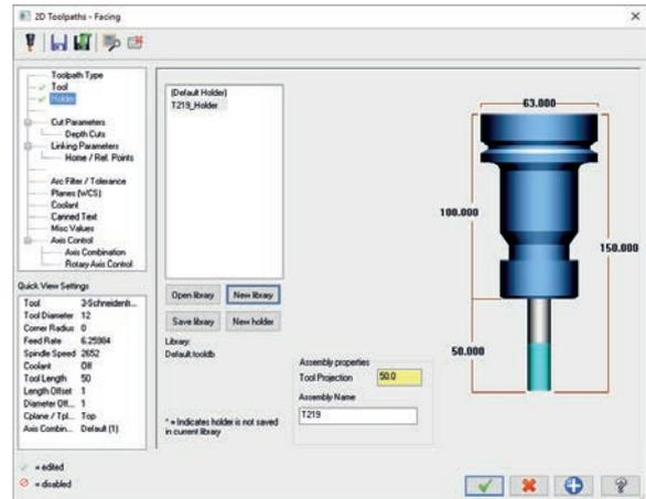
Die Übergabe aller Technologie- sowie Geometriedaten in das CAM-System passiert mit zwei Klicks. Durch die absolut nahtlose Integration in das CAM-System sind sogar Änderungen oder Auswechslungen von Komplettwerkzeugen im fertig programmierten Teil möglich.
