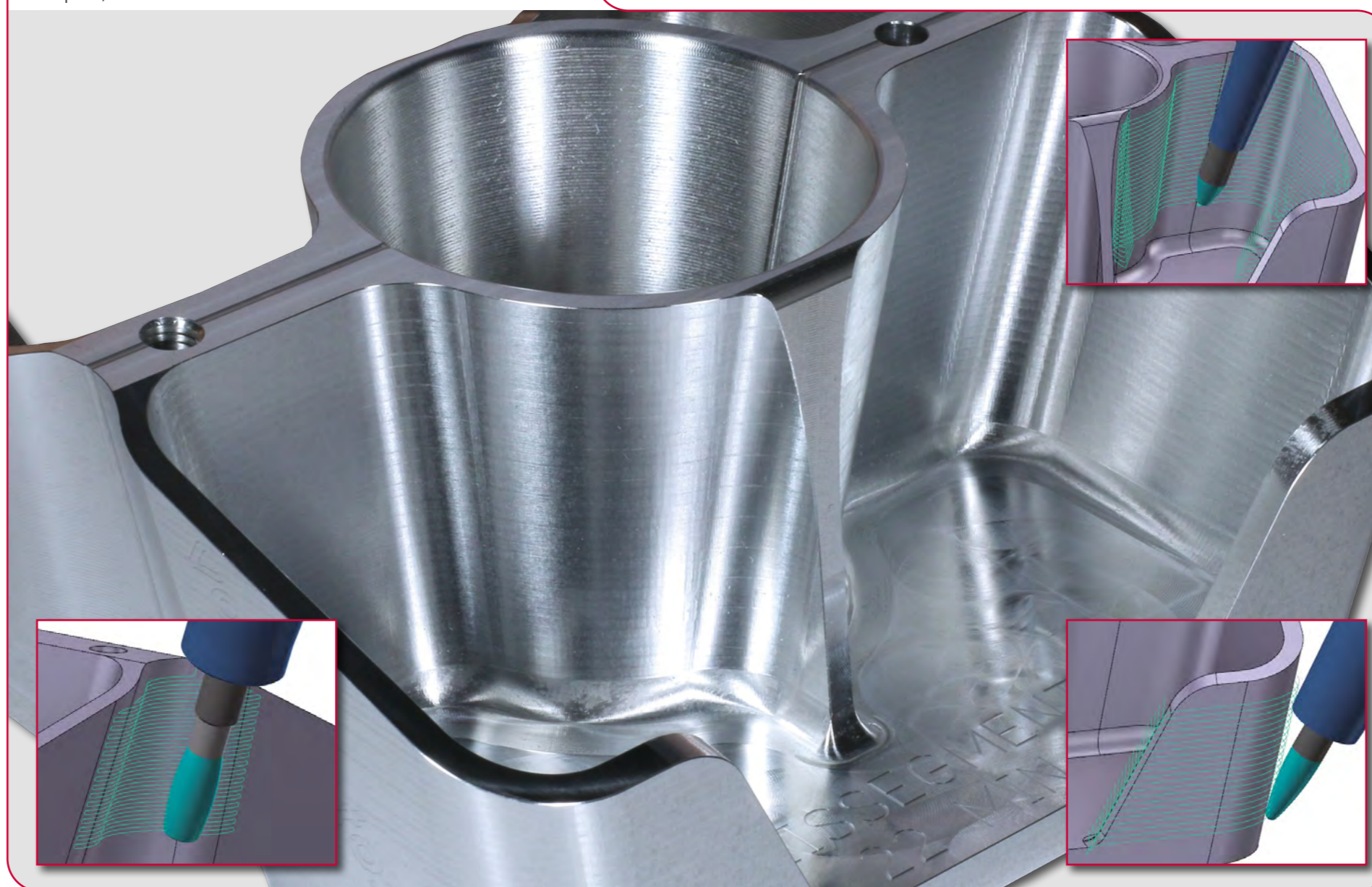
Folgende Formen stehen zur Verfügung (v.l.n.r.): Kegel-, Tonnen-, Tropfen-, Linsen- und Linsentonnenform
